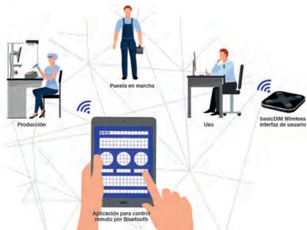
La base del control inalámbrico se puede conseguir con los nuevos drivers integrados con bluetooth o con un driver normal y el módulo **basicDIM Wireless**. Los perfiles de control se guardan durante la fase de producción de la luminaria. Los usuarios pueden escoger si controlan la iluminación mediante aplicación de control remoto por Bluetooth o con la interfaz de usuario.
